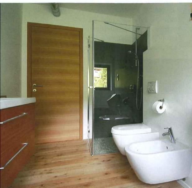
I TETTI DEI BAGNI SONO ATTRAVERSATI DAI CANALI PER L'AERAZIONE DEGLI AMBIENTI. CIO' EVITA LA FREQUENTE APERTURA DEGLI INFISSI CHE FAREBBE USCIRE IL CALORE. MOLTA CURA È STATA RIPOSTA PER EVITARE PONTI TERMICI.
